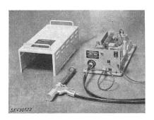
Steuerstromkreis sowie Röhrengleichrichter für den Hochspannungsgenerator. Transformator mit getrennten Wicklungen, durch Kleinsicherungen geschützt. Zuleitung mit Stecker  $2\ P+E$ , fest angeschlossen.
