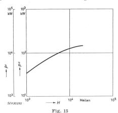
Notwendige Leistung eines Fernseh-Rundfunk-Satelliten in Abhängigkeit von der Satellitenhöhe für Signale von 5 mV/m und  $500~\mu$ V/m (nach Haviland [5])
