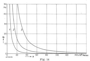
Noch zu empfangende Bandbreite bei einer Sendeleistung von 150 W und einer Frequenz von 400 MHz in Abhängigkeit von der Entfernung und des Durchmessers der Parabolantenne der Bodenstation (nach Haviland [6])
