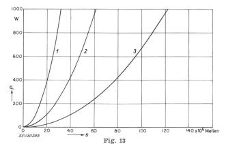
Notwendige Sendeleistung bei einer Frequenz von 400 MHz und einer Bandbreite von 10 Hz in Abhängigkeit von der Entfernung und des Durchmessers der Parabolantenne der Bodenstation (nach Haviland [6])
