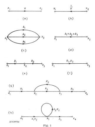
Prinzip der graphischen Darstellung a einfachste Darstellung; b Inversion von a; c mehrfache Verbindung; d Vereinfachung von c; e Hintereinanderschaltung; f Elimination des mittleren Punktes in e; g Rückführung; h Transformation der Rückführung aus g in eine Schleife
