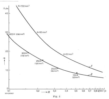
Kostenvergleich zwischen Papierbleimantelkabel und «Solidal»-Kabel für gleichen Widerstand pro Kabellänge
