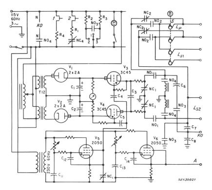
Fig. 1 Impuls-Generator zur Prüfung von Motor-Wicklungen
