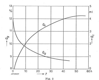
Abnahme des Gasgehaltes im Öl $G_g$  und die Menge des aufgefangenen Gases  $G_o$  in Funktion der Zeit t nach der Druckentlastung an der Öloberfläche von 0,5 kg/cm² auf 0,035 kg/cm²
