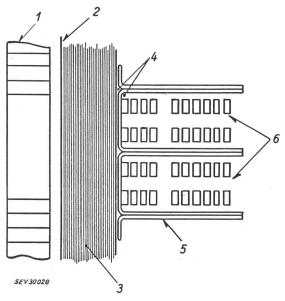
Fig. 1 Schnitt durch Wicklungsteil mit Ölzwischenräumen, in denen bei Anwesenheit von Gas Entladungen auftreten können
