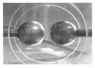
Fig. 3 Gasbildung an spannungsbeanspruchten Elektroden unter gasübersättigtem Öl
