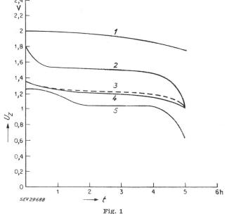
Entladekennlinien verschiedener Sekundärbatterien Klemmenspannung  $U_z$  in Funktion der Zeit t bei Entladung innert 5 h und bei 25 °C
