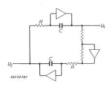
Fig. 1 Schaltung zur Lösung einer Differentialgleichung
