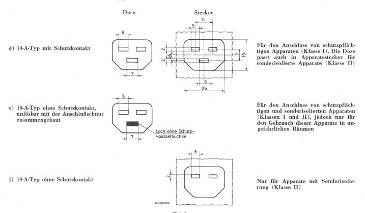
Fig. 2 Apparatesteckdosen und Apparatestecker 250 V für warme Anschlußstellen bis 155  $^{\circ}\mathrm{C}$
