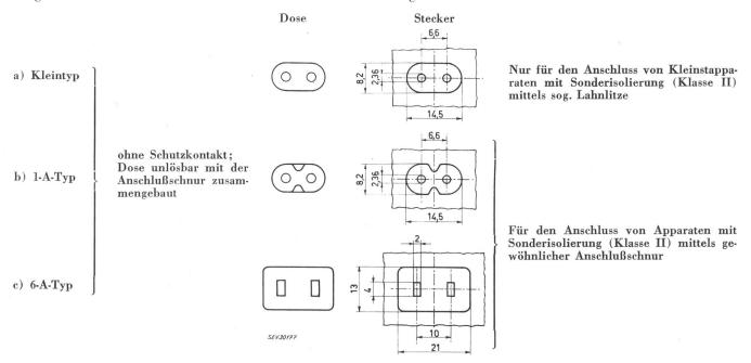
Fig. 1 Apparatesteckdosen und Apparatestecker 250 V für kalte Anschlußstellen bis 65  $^{\circ}$ C
