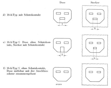
Fig. 3 Apparatesteckdosen und Apparatestecker 250 V für warme Anschlußstellen bis 155 °C
