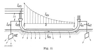
Strom- und Spannungsverlauf eines nackten, an die Hochspannungserdung HE geerdeten Kabelmantels im Erdboden
