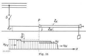
Eindringen einer Spannungswelle aus der Freileitung F in ein im Übergang P nicht geerdetes Kabel
