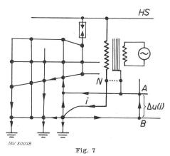
Entstehung der Störspannung  $\Delta u(i)$  zwischen den Punkten A und B infolge der Betriebserdung des Transformator-Nullpunktes N HS Hochspannungsleitung; i Nullpunktstrom
