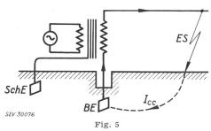
Getrennte Betriebserdung BE (bis 1943) und Schutzerdung SchE  $I_{cc} \ {\it Kurzschlußstrom infolge des Erdschlusses} \ ES$
