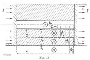
Schleifenspannungen am Voltmeter V für verschiedene Schleifen 1, 2, 3, 4
