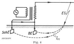
Verbundene Betriebserdung BE und Schutzerdung SchE  $I_{ac}$  Kurzschlußstrom infolge des Erdschlusses ES
