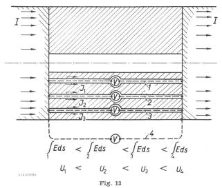
Spannung U an verschiedenen Achsenabständen in einem dickwandigen Kabelmantel, der von einem hochfrequenten Wechselstrom I durchflossen ist
