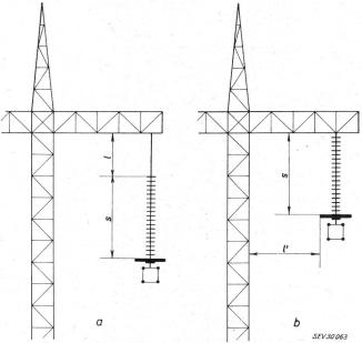
Fig. 1 Befestigungsart der Isolatorenkette
