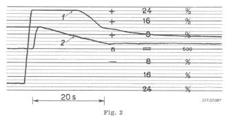
Groupe de 56 MW de Fionnay Grande-Dixence Décharge brusque de 51 MW avec régleur électrique «Erelstat» 1 Relevé du mouvement des déflecteurs
