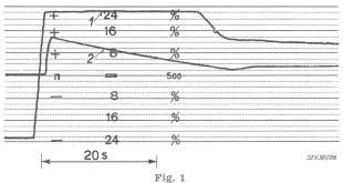
Groupe de 56 MW de Fionnay Grande-Dixence Décharge brusque de 51 MW avec régleur mécanique
