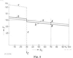
Fonctionnement d'un groupe équipé d'un dispositif suppresseur à seuils Vevey
