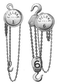
CM Cyclone M Stirnradflaschenzüge mit legierten «Alcoa» Aluminiumgehäuse und «Herc-Alloy»-Lastkette, 0,5—10 t, sind sehr leicht. 6 t mit nur 640 mm Bauhöhe und 3,6 m Standardhub wiegt nur 66 kg. Diese Züge werden in der Schweiz in sehr grosser Zahl ganz besonders für Montagearbeiten verwendet.
