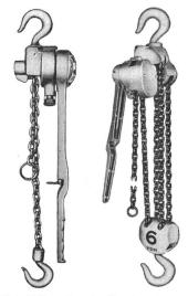
CM Puller Rätschenflaschenzüge mit legiertem «Alcoa» Aluminiumgehäuse und «Herc-Alloy»-Lastkette, ¾—6 t, sind überaus handlich. 3 t mit nur 420 mm Bauhöhe und 1,5 m Standardhub wiegt nur 15,4 kg. Standardzug beim Freileitungsbau.
