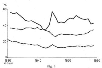
Relative Kennwerte für Netzhöchstlast, installierte Transformatorenleistung für Niederspannung und Anschlusswert
