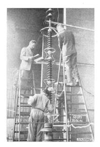
Versuchsanordnung einer 220-kV-Hängekette
