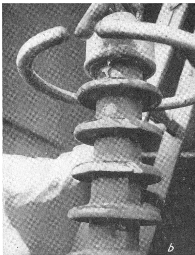
Fig. 5 Zerstörungen an Isolatoren nach einem Lichtbogenüberschlag In c wurde der Lichtbogen auf die Isolierkappe gezündet. Von dort ist er nicht auf das Horn übersprungen
