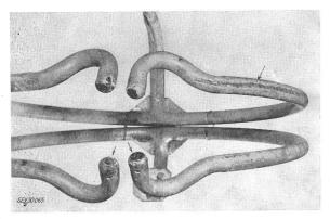
Fig. 1 Schutzarmaturen einer 220-kV-Isolatorenkette nach einem Erdschlusslichtbogen, gezündet durch einen Blitz Die Fortleitung des Lichtbogens an die offene Stelle ist an den Brandspuren ↑ gut zu verfolgen (EWZ 1960)
