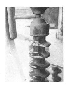
Fig. 5 Zerstörungen an Isolatoren nach einem Lichtbogenüberschlag In c wurde der Lichtbogen auf die Isolierkappe gezündet. Von dort ist er nicht auf das Horn übergesprungen
