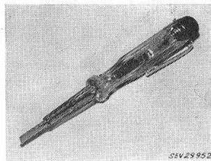
Der Schraubenzieher mit Spannungsanzeiger hat die Prüfung in sicherheitstechnischer Hinsicht bestanden.
