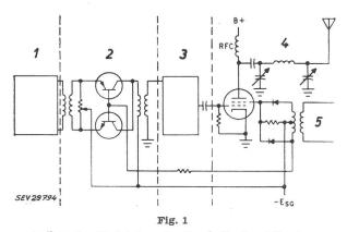
Aufbau des Modulators des Zweiseitenband-Senders
