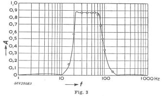
Verlauf der Übertragungsfunktion des Bandpassfilters
