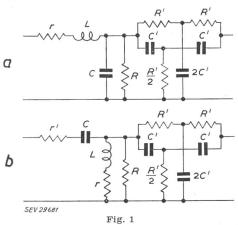
Varianten des Filters a Tiefpassfilter; b Hochpassfilter
