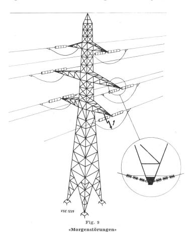
Skizze eines Winkel-Abspannmastes. Auf diesem Mast ereigneten sich die Morgenstörungen
