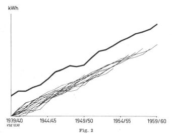
Beispiel einer Trenduntersuchung mit der Roßschwanzmethode Dick ausgezogene Kurve: Urkurve (Inlandverbrauch ohne Elektrokessel und Speicherpumpen; logarithmischer Maßstab)
