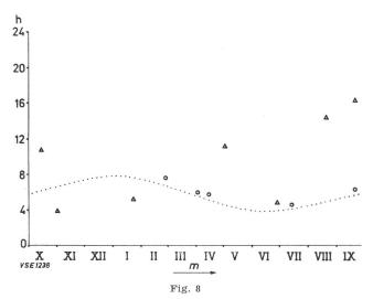
Statistik über die Störungen auf den Hochspannungsleitungen «Morgenstörungen» und Störungen aus andern Gründen (Blitzschläge, Isolatorendefekte usw.). Leitungen der EOS Romanel—
