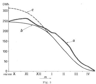
Statistik über die Ausnutzung der Speicherenergie. Jahr 1954/55 Das Bild zeigt deutlich, wie die ungenügende Speicherfüllung durch stark reduzierte Bezüge von Speicherenergie in den Monaten Oktober und November kompensiert werden musste
