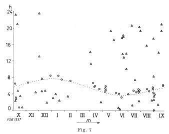
Statistik über die Störungen auf den Hochspannungsleitungen «Morgenstörungen» und Störungen aus andern Gründen (Blitzschläge, Isolatorendefekte usw.). Leitungen der EOS Romanel—
