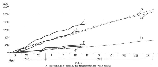
Niederschläge (progressive Summenwerte) bei der Staumauer Dixence, in Hérémence (Val d'Hérémence), auf der Passhöhe des Grossen St. Bernard und auf der Gotthard-Passhöhe. Man beachte die beträchtlichen Unterschiede der durchschnittlichen Niederschlagshöhen für die verschiedenen Orte
