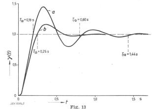
Regelzeit und Anregelzeit für zwei Übergangsfunktionen mit verschiedener Dämpfung
