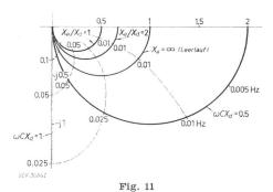
Frequenzgang eines Synchrongenerators mit reiner Blindlast  $X_{\sigma}$  Belastungsreaktanz bei induktiver Belastung; C Belastungskapazität bei kapazitiver Belastung;  $X_{d}$  Synchronreaktanz der Längsachse;  $\omega = 2\pi f$  Kreisfrequenz
