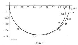
Frequenzgang einer Gleichstrommaschine (Erreger)  $\alpha$  im Leerlauf; b belastet auf das Polrad einer Synchronmaschine
