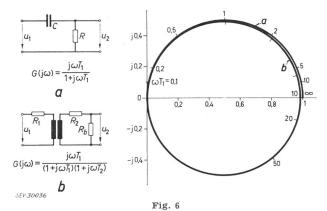
Frequenzgang von Differenziergliedern a RC-Glied; b Differenziertransformator mit Widerstandslast
