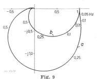
Frequenzgang der gesamten Regeleinrichtung a bei günstig eingestellter Rückführung; b ohne Rückführung
