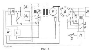
Beispiel einer Spannungsregelung mit Transduktoren
