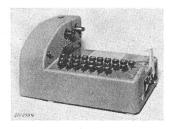
schaltbar für 110...250 V und weist getrennte Wicklungen auf. Speisung des Motors durch Selengleichrichter. Bei Netzausfall ist Betrieb mit 12 V-Akkumulator möglich. Dieser Akkumulator kann mit dem eingebauten Gleichrichter geladen werden. Schutz gegen Überlastung durch Kleinsicherung im Primärstromkreis und je einen thermischen Auslöser im Motor- sowie im Lade-Stromkreis. Apparatestecker 6 A 250 V 2 P +E für den Netzanschluss.
