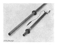
Der Spannungsanzeiger hat die Prüfung in sicherheitstechnischer Hinsicht bestanden. Verwendung: in trockenen Räumen sowie im Freien mit Ausnahme bei Regen, nur durch instruiertes Personal. Gültig bis Ende September 1963.
