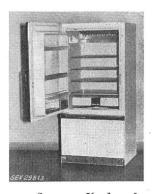
mit zusammenhängenden Wicklungen. Separate Verdampfer für Kühlraum und Tiefkühlfach. Temperaturregler mit Ausschaltstellung. Zwei Glühlampen mit Türkontakten. Automatische Abtauvorrichtung. Heizelemente für Butterfach und Abtauung der Verdampfer. Vorne im Gehäuse eingebaute Heizleiter verhindern Festsitzen der Türdichtungen. Gehäuse aus lackiertem, Wandungen von Kühlraum und Tiefkühlfach aus emailliertem Blech. Zuleitung Doppelschlauchschnur mit Stecker 2 P + E, fest angeschlossen.
