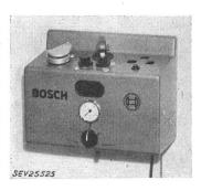
Druckkammer mit Manometer, Druckablaßschraube und Sandstrahl-Vorrichtung. Dreiadrige Zuleitung mit 2P+E-Stecker, fest angeschlossen.
