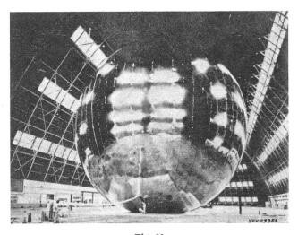
**Fig. 10**Kunststoff-Satellit für Echozwecke im Prüfstand
