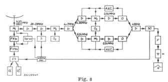
Blockschema eines Empfängers (nach C. A. Müller)
