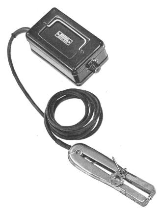
T-isolierte Drähte von 1 mm² bis 16 mm² können dank den elektrisch beheizten Schneidebacken mühelos abisoliert werden. Die Isolation wird durchgeschmolzen und die Form der Schneidebacken verhindert das Einschneiden der Leiter.
