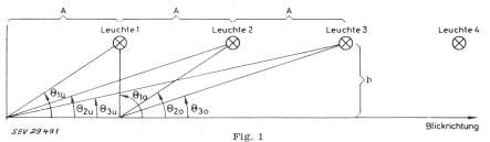
Entstehung von Lichteinfallwinkelbereichen einzelner Leuchten im Verlaufe einer Streckenperiode  $\theta$  Winkel zwischen Blickrichtung und der Lichteinfallsrichtung; A Leuchtenabstand
