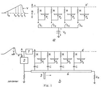
Prinzip und Arbeitsweise des «Zeit-Folge»-Teinographen  $\alpha$  Grundprinzip; b Arbeitsweise bei schnellen Stössen 1 Stossverzögerung; 2 Impuls-Generator; 3 Impuls  $V_0$ ; 4 Impulsverzögerungsleitung
