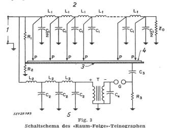
1 Stoss-Eingang; 2 Stossverzögerungsleitung; 3 Metallplatte; 4 dielektrische Oberfläche; 5 Impulsverzögerungsleitung
