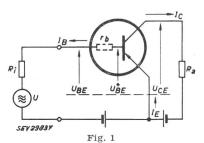
Ersatzschaltung eines Transistors
