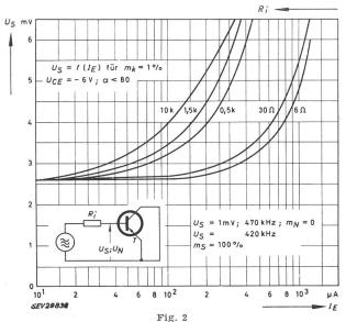
Einfluss des Generatorinnenwiderstandes  $R_i$  und des Emitterstromes  $I_E$  auf die effektive Störspannung  $U_S$   $I_B$  Basisstrom;  $I_c$  Kollektorstrom;  $U_{CE}$  Kollektor-Emitterspannung
