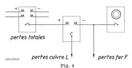
Répartition des pertes totales en pertes cuivre et pertes fer
