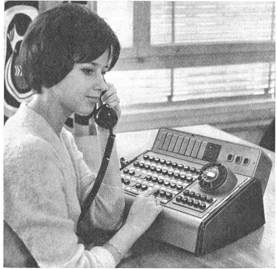
Fig. 2 «Albis»-Vermittlungsstation mit Leuchttasten und eingebautem Nummernanzeiger
