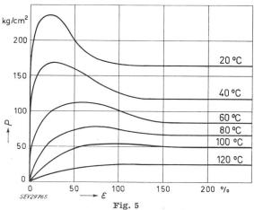
Relative Dehnung  $\epsilon$  eines Polyäthylens in Funktion der Zugspannung P bei verschiedenen Temperaturen Werkstoff: Ziegler-Polyäthylen
