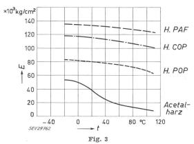
Elastizitätsmodul E in Funktion der Temperatur t H.POP, H.PAF (Phenoplaste) H.COP (Carbamidharz) sind gehärtete Kunststoffe; Acetalharz ist ein aus Formaldehyd hergestellter Thermoplast
