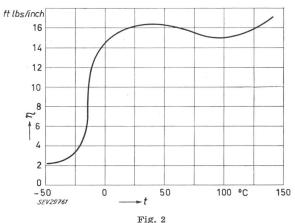
Kerbschlagzähigkeit  $\eta$  von Polycarbonat in Funktion der Temperatur t
