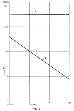
Verlauf des Isolationswiderstandes  $R_{is}$  von Papierkondensatoren bei 60 °C und 95...100 % relativer Luftfeuchtigkeit t Zeit; 1 alte Ausführung: Kunstharz-Becher (Deckelverschluss); 2 neue Ausführung: Aluminium-Becher mit Araldit-
