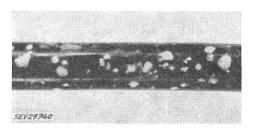
Fig. 10 Von Mikroorganismen angegriffener Polyvinylchlorid-Kabelmantel
