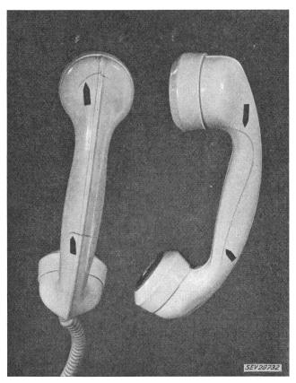
Fig. 2 Spannungsrisse an Mikrotelephonen aus Melaminharz
