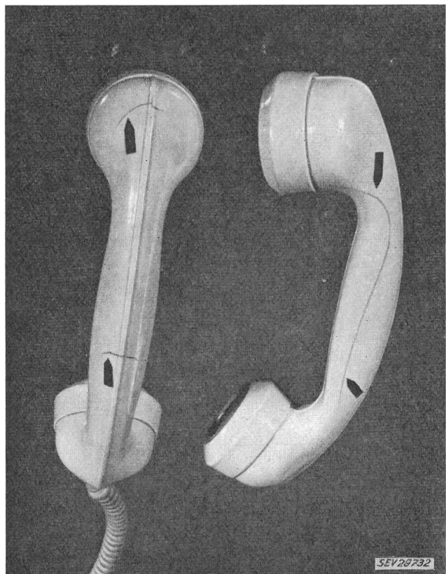
Fig. 2 Spannungsrisse an Mikrotelephonen aus Melaminharz
