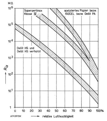
Fig. 6 Isolationswiderstand von Sicherungsserien  $20 \times 2$  mit verschiedenen Hartpapierisolationen  $R_{4s}$  Isolationswiderstand
