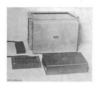
Schlaufenkasten mit Endverstärker und Transistoren, Netztransformator mit 3 getrennten Gleichrichtern. Rufempfänger in Spital- bzw. Industrieausführung. Anschluss für Induktionsschlaufe. Schutz gegen Überlastung durch Kleinsicherungen. Die Personensuchanlage entspricht den «Vorschriften für Apparate der Fernmeldetechnik» (Publ. Nr. 172). Verwendung: in trockenen Räumen.
