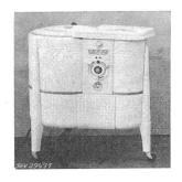
Hilfswicklung und Zentrifugalschalter. Laugepumpe vorhanden. Mechanische Vorrichtung zum Umschalten des Getriebes für Waschen, Zentrifugieren und Pumpen. Zeitschalter und Druckknopfschalter für Motor, Stufenschalter für Heizung, Signallampe und Zeigerthermometer eingebaut. Zuleitung Gummiaderschnur mit Stecker 3 P + N + E, fest angeschlossen. Handgriff aus Isolierpreßstoff.
