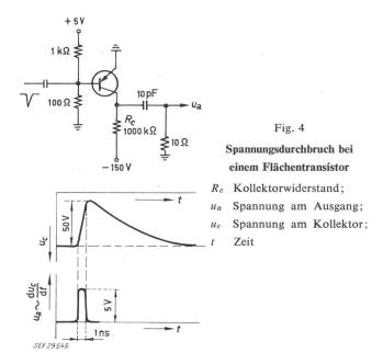
Fig. 4 zeigt eine gebräuchliche Transistorschaltung, welche den Lawinendurchbruch am Kollektor eines Flächentransistors ausnützt. Bei gesperrter Emitterstrecke wird durch den Kollektorwiderstand  $R_c$  ein Strom von etwa 1 mA erzwungen, so dass die Kollektorspannung nahezu die Durchbruchspannung erreicht. Sobald ein Auslöseimpuls die
