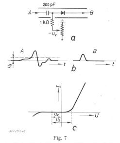
Amplitudendiskriminierung mit Mikrowellendioden
