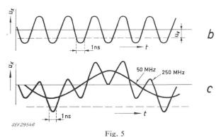
Pulsgenerator mit harmonischer Vervielfachung und Resonanzverstärkung
