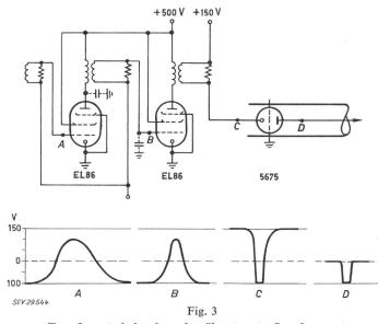
Transformatorisch gekoppelter übersteuerter Impulsgenerator
