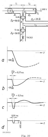
Aufbau und Spannungsverlauf eines doppelten Differenziernetzwerkes a,b,c,d Spannungsverlauf an den entsprechenden, in der Schaltung gekennzeichneten Messpunkten  $l_1=l_2=2.5$  cm;  $l_3=5$  cm;  $Z_1=Z_2=100$   $\Omega$ ;  $Z_3=Z_4=50$   $\Omega$ ;  $Z_5=25$   $\Omega$ ;  $C_1=10$  nF;  $C_2=400$  nF; t Zeit
