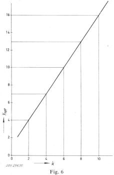
Capacité optima  $y_{opt}$  en fonction du paramètre k=2  $T\sqrt{NT}$   $y_{opt}$  Capacité optima du concentrateur
