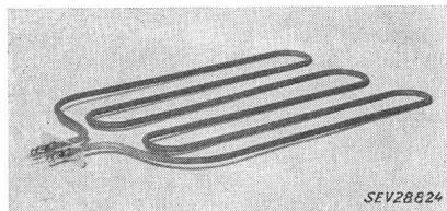
2,4 m Länge schlaufenförmig gebogen. Enden mit Gummidichtung auf Flansch mit Erdungsstift geführt.
