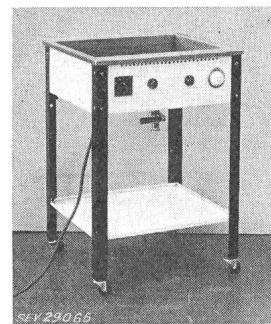
ter und zwei Signallampen vorne im Gehäuse eingebaut. Öl- ablaufhahn unten am Ölbehälter. Zuleitung Doppelschlauch- schnur 3 P + E, fest angeschlossen.
