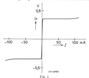
Kennlinie eines monostabilen Cryosars
