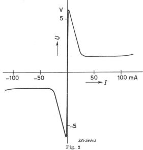
Kennlinie eines bistabilen Cryosars
