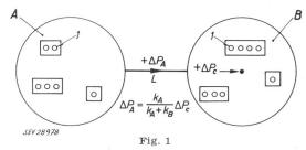
Réglage de 2 réseaux A et B interconnectés réalisé par les régulateurs de vitesse
