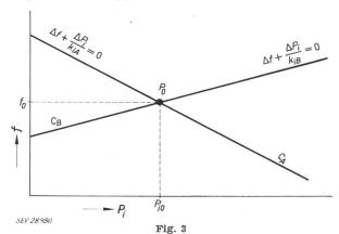
Caractéristique du réglage fréquence-puissance de deux réseaux interconnectés
