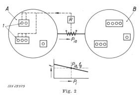
Réglage de 2 réseaux A et B interconnectés réalisé par un régulateur fréquence-puissance R
