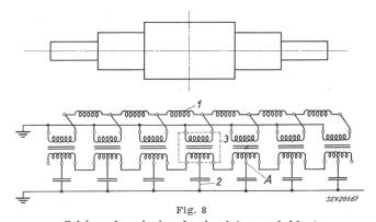
Schéma de principe du simulateur précédent 1 bobine d'induction; 2 capacité; 3 transformateur; A point de mesure pour la détermination de la ligne élastique
