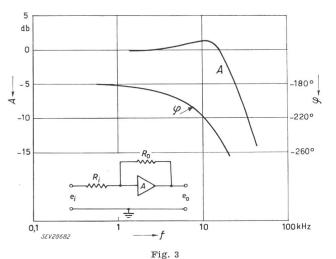
Diagramme de Bode d'un amplificateur opérationnel  $R_0=R_t=1~\mathrm{M}\Omega$  A amplification;  $\varphi$  phase; f fréquence;  $R_t$  résistance d'entrée;  $R_0$  résistance de contre-réaction
