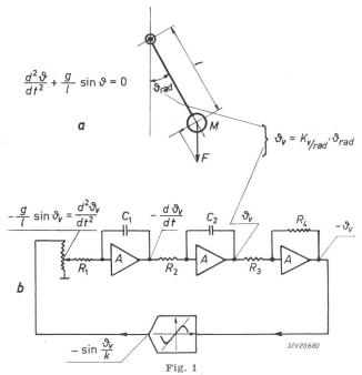
Analogie électronique d'un système mécanique Le pendule (a) et le circuit électronique (b) ont des équations de fonctionnement de même forme. On dit qu'ils sont analogues. A amplificateur;  $C_1$ ,  $C_2$  capacités; F force; g gravitation; K koefficient de proportionnalité; l longueur; M masse;  $R_1$ ,  $R_2$ ,  $R_3$ ,  $R_4$  résistances; t temps;  $\mathcal{P}$  angle;  $\mathcal{P}_v$  tension électrique
