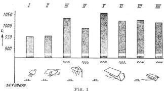
Anordnung der Leuchten der Beleuchtungssysteme I...VIII und die für jedes System erreichten Leistungen Durchschnittswert von je 15 Versuchen mit je
