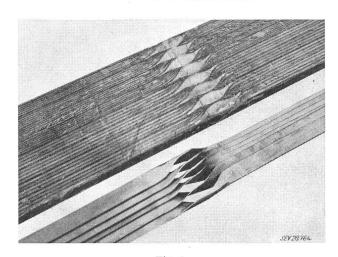
Fig. 6 **Teilleiterbündel-Stab** 180 °-Verdrillung der Teilleiterbündel in der Nutmitte
