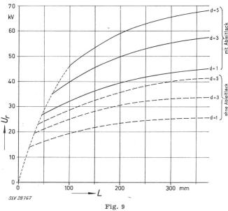
50-Hz-Randüberschlag-Spannung  $\boldsymbol{U}_r$  von Nutenisolationen L Ausladung der Nutenisolation
