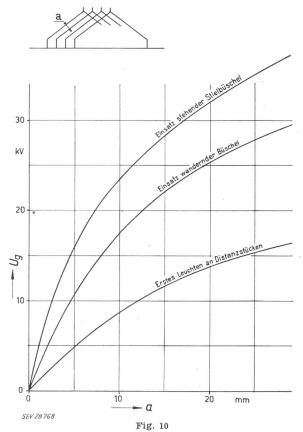
Glimmeinsatz-Spannungen  $U_g$  in Wicklungsköpfen Asphaltimprägnierte Micaband-Isolation mit Glimmschutz-Anstrich a Luftdistanz im Spulenkopf
