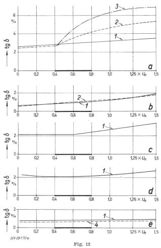
Spannungsabhängigkeit des tg $\delta$  verschiedener Isolationen a Schellack-Micafolium; b Epoxy-Samicafolium; c mit Polyester vorimprägniertes Samicaband; d asphalt-vakuumimprägnierte Micabänder; e epoxy-vakuumimprägnierte Samicabänder
