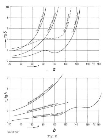
Temperaturabhängigkeit des tg $\delta$  verschiedener Isolationen a Vorimprägnierte Folien-Isolationen; b Vakuumimprägnierte Bandisolationen; t Temperatur
