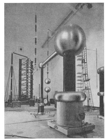
Fig. 2 Störspannungsmessplatz für Höchstspannungsmaterial bis 420 kV
