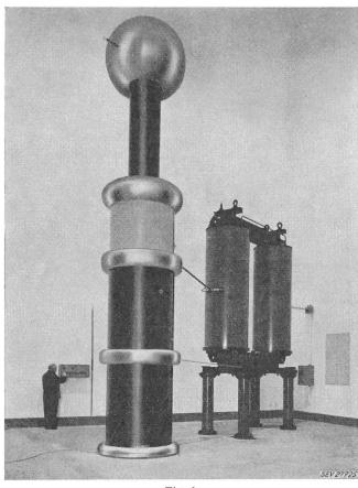
Fig. 1 Transformatoren-Kaskade für 1 000 000 V, 50 Hz
