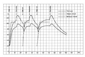
Fig. 6 Verlauf der Temperaturen des «Steri-Vap Jura» als Funktion der Zeit
