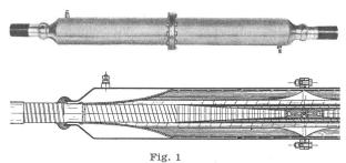
Verbindungsmuffe für 220-kV-Hochspannungs-Ölkabel
