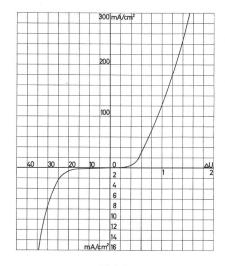
Fig. 1 Kennlinie der Hochleistungsausführung eines Selen-Gleichrichterelementes
