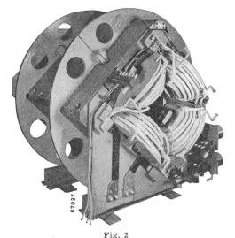
Quadrupol-Magnet zur Fokussierung von Strahlenbündeln
