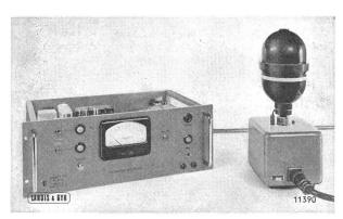
Fig. 6 Gewebeäquivalente Ionisationskammer
