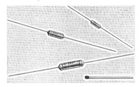
Fig. 1 Tantal-Kondensatoren
