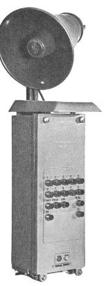
Trennerantriebes an bis zum Anzeigeorgan (Quittungsschalter) dauernd überwacht. Störungen im Meldeablauf werden optisch und akustisch angezeigt. Die Dauer eines Schaltbefehles bis zum Eintreffen der neuen Meldung beträgt ca. 2,5 s.
