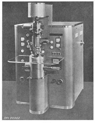
Fig. 1 Elektronenemissions-Oberflächenmikroskop
