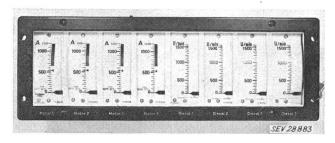
Fig. 2 Achtfachinstrument für Lokomotiv-Führerstand
