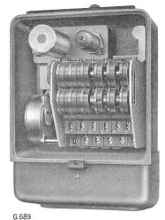
Fig. 3 Netzkommando-Empfänger für 6 Doppelbefehle
