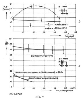
a Durchschlagspannung, b Streuzeit  $\sigma$  und Aufbauzeit  $\tau$ , abhängig vom Wassergehalt des Öles bei Stoßspannung VDE-Elektroden, 1 mm Schlagweite, 1 | 40- $\mu$ s-Welle
