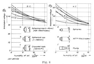
Durchschlagspannung in  $\eth$ i, abhängig vom Wassergehalt Schlagweite a=2.5 mm bei Gleich- und Wechselspannung; Regelzeit ca. 35 s bis zum Durchschlag
