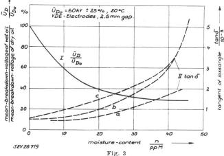
Abnahme der Durchschlagspannung  $U_D$  und Anstieg des Verlustfaktors tg  $\delta$  mit steigendem Gehalt des Öles an Feuchtigkeitsspuren
