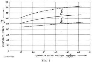
Durchschlag-Wechselspannung  $U_D$  eines trockenen Öles, abhängig von Spannungssteigerungsgeschwindigkeit VDE-Elektroden, 2,5 mm Abstand
