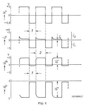
Zeitlicher Strom- und Spannungsverlauf 1 Ein; 2 Aus Weitere Bezeichnungen siehe Text
