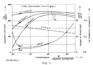
Temperaturabhängigkeit von Durchschlagfestigkeit (VDE-Kalotten), Verlustfaktor, Elektrisierungsziffer und Zähigkeit verschiedener feuchter Transformatorenöle  $a\approx 0$ , b=15, c=45 mg/kg Wassergehalt
