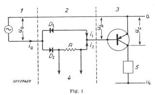
Schaltschema zur Erfassung der Transistor-Temperatur 1 Spannungsquelle; 2 Messglied; 3 Transistor und Last; 4 zum Differentialverstärker; 5 Last
