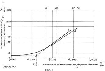
Feuchtigkeitsgehalt bei Sättigung des Öls mit Wasser, abhängig von der Temperatur [2; 3]
