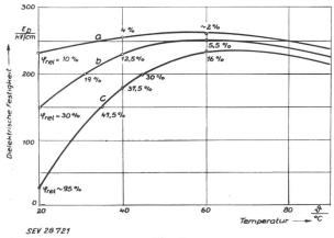
Fig. 5 **Durchschlagfestigkeit nach Fig. 4** Parameter ist die relative Feuchtigkeit  $\varphi$  in %  $a=4.5~{\rm ppM};~b=15~{\rm ppM};~c=45~{\rm ppM}$
