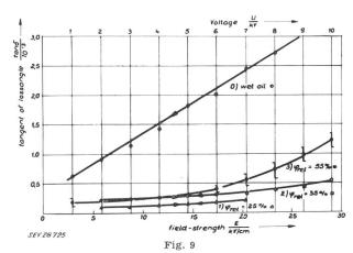
Verlustfaktor (tan  $\delta$ ) in Öl verschiedener Feuchtigkeit, abhängig von der Feldstärke E (bei 22 °C) |  $\varphi_{rel} = 25~\%; 2)~\varphi_{rel} = 35~\%; 3)~\varphi_{rel} = 55~\%; 0)~\varphi_{rel} \approx 95~\%$
