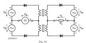
Magnetverstärker nach Ramey in Gegentaktschaltung, mit 2 Transduktoren
