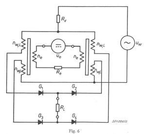
Magnetverstärker mit kurzer Steuerzeit für Signale wechselnder Polarität, ohne Hilfstransduktoren
