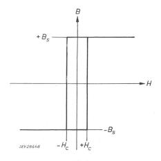
Fig. 1 Idealisierte Hysteresis-Schleife eines ferromagnetischen Magnetkern-Materials B Induktion;  $B_{\delta}$  Sättigungsinduktion;
