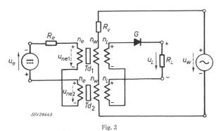
Magnetverstärker mit kurzer Steuerzeit für Signale gleichbleibender Polarität
