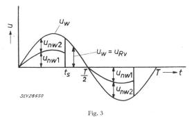
Spannungsverlauf des Verstärkers nach Fig. 2, ohne Aussteuerung
