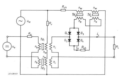
Die Steuerspannung  $u_e$  sei wiederum als gleichgerichtete Sinusspannung der Speisefrequenz angenommen.
