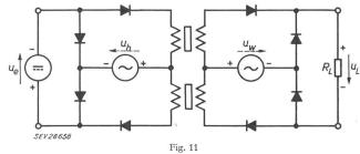
Magnetverstärker nach Ramey in Brückenschaltung, mit 2 Transduktoren
