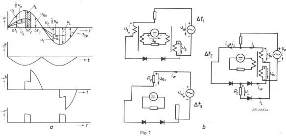
Zeitlicher Verlauf der Spannungen und Strompfade des Verstärkers nach Fig. 6 bei Aussteuerung w Speisestrom;  $\Delta t_1$  Zeitspanne der Magnetisierung beider Transduktoren;  $\Delta t_2$  Ausgangs-Impulszeit;  $\Delta t_3$  Zeitspanne der Sättigung beider Transduktoren. Weitere Bezeichnungen siehe Fig. 3, 4 und 6
