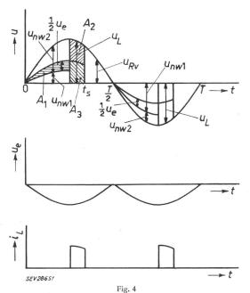
Spannungsverlauf des Verstärkers nach Fig. 2 bei Aussteuerung
