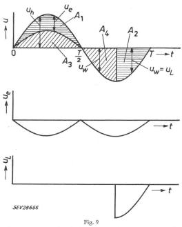
Spannungsverlauf des Verstärkers nach Fig. 8  $u_e$  Eingangsspannung;  $u_L$  Ausgangsspannung;  $u_w$  Speisespannung;  $u_h$  Hilfswechselspannung; t Zeit;  $A_1...A_4$  Spannungszeitflächen (s. Text)
