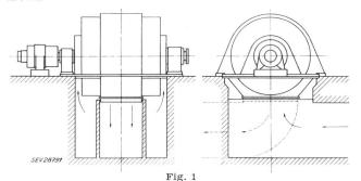
Alternateur triphasé de 10,6 MVA Schéma du système de refroidissement par aspiration d'air à l'extérieur de la salle des machines
