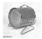
Bei blockiertem Motor wird die Heizung durch eingebauten Temperaturschalter ausgeschaltet. Ofen auf Metallrohrfuss schwenkbar gelagert. Anschlagestifte verhindern zu starke Neigung nach unten. Handgriff vom Gehäuse isoliert. Versenkter Apparatestecker für die Zuleitung.
