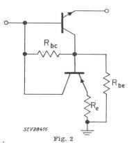
Eingangsstufe mit lastunabhängiger Eingangsimpedanz, die in einem weitern Bereich eingestellt werden kann
