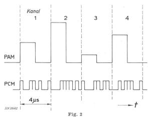
Prinzip des Zeit-Multiplex-Übertragungssystems PAM Puls-Amplituden-Modulation; PCM Puls-Code-Modulation; t Zeit
