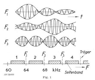
Prinzip des Frequenz-Multiplex-Übertragungssystems  $t \ \ {\it Zeit}; \ \ F_1, \ F_2, \ F_3 \ {\it Tr\"{a}} {\it gerfrequenzen}$
