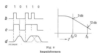
a Codezahl; b getrennte Impulse; c zusammenhängende Impulse; d Impulsform nach einem Tiefpassfilter
