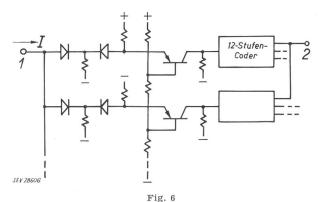
Schaltschema eines Parallelcoder 1 Signal-Eingang; 2 Digit-Ausgang
