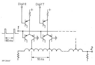
Fig. 7 Schaltschema eines Parallel-Serie-Wandlers 1 Torimpulse; 2 Ausgang
