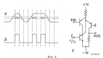
$\begin{array}{c} \textbf{Wirkungsweise eines Regenerators} \\ a \ \text{Eingangsspannung}; \ b \ \text{Ausgangsspannung}; \ c \ \text{Schaltung} \end{array}$
