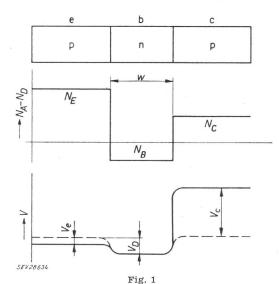
Konzentrations- und Potentialverlauf in einem p-n-p-Transistor e Emitter; b Basis; c Kollektor
