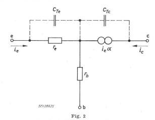
Ersatzschaltbild des Transistors e Emitter; b Basis; c Kollektor
