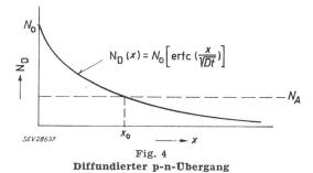
$N_A$  Akzeptorenkonzentration im Halbleiterkristall;  $N_0$  Donatorenkonzentration an der Oberfläche des Halbleiters;  $N_D(x)$  Donatorenkonzentration im Kristall; x Entfernung von der Oberfläche (Tiefe);  $x_0$  Tiefe des entstandenen p-n-Überganges; D Diffusionskonstante; t Zeit
