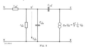
Hybrid- $\Pi$ -Ersatzschema des Transistors in der Emitterschaltung
