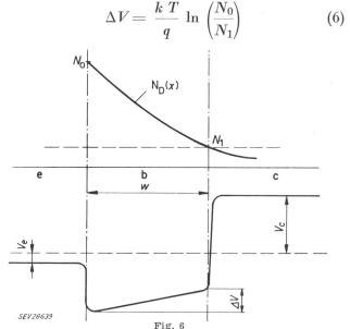
Konzentrations- und Potentialverlauf in einem Drifttransistor e Emitter; b Basis; c Kollektor
