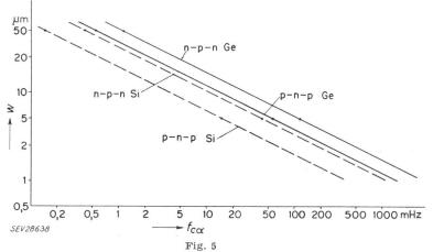
Grenzfrequenz als Funktion der Basisbreite für legierte Transistoren
