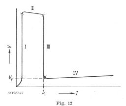
Charakteristik eines p-n-p-n-Transistors
