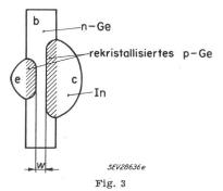
Legierter p-n-p-Transistor e Emitter; b Basis; c Kollektor w Basisbreite; In Indium; Ge Germanium
