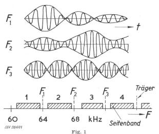
Prinzip des Frequenz-Multiplex-Übertragungssystems t Zeit;  $F_1$ ,  $F_2$ ,  $F_3$  Trägerfrequenzen
