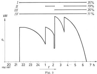
Programm für die Einschaltung der Heisswasserspeicher in Haushaltungen und sich daraus ergebendes Belastungsdiagramm eines städtischen Verteilnetzes (Elektrizitätswerk der Stadt Zürich)
