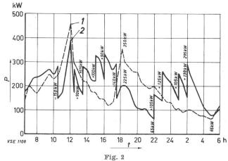
Mit einer Netzkommandoanlage erzielte Verbesserung der Belastungskurve in einem ländlichen und halbstädtischen Niederspannungsverteilnetz
