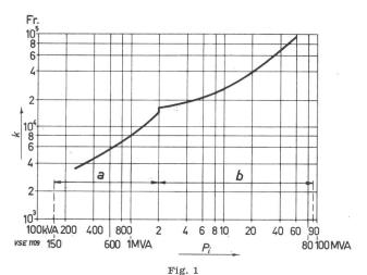
Kosten einer Netzkommando-Sendeanlage in Abhängigkeit der Leistung des Hochspannungs/Mittelspannungs-Unterwerkes, in dem die Sendeanlage installiert ist (im Fall der Mittelspannungs-Einspeisung) oder der gesamten Leistung aller Transformatorenstationen Mittelspannung/Niederspannung (im Fall
