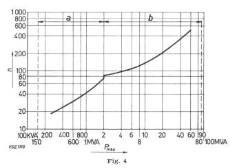
Mindestanzahl der Empfänger, die in einem Netz installiert werden müssen, damit sich die Einführung einer Netzkomkommandoanlage lohnt
