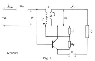
Schaltschema des Steuerverstärkers mit Transistor und sättigbarem Stromwandler
