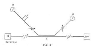
Messung von Frequenz und Leistung der dem Modulator zugeführten Spannungen
