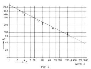
Impedanzmessung der Eigenresonanzfrequenz  $f_0$  von Scheibenkondensatoren
