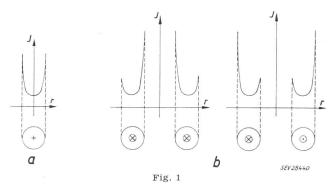
Stromdichte J als Funktion des Ortes r auf dem Leiterquerschnitt
