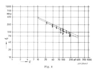
Absorptionsmessungen der Eigenresonanzfrequenz von Rohrkondensatoren
