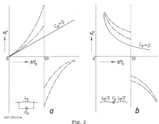
Blindwiderstand von Schaltelementen als Funktion des Verhältnisses Betriebsfrequenz f zur Eigenresonanzfrequenz f<sub>0</sub>
