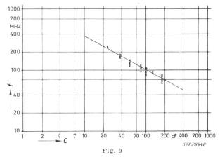
Absorptionsmessungen der Eigenresonanzfrequenz von Rohrkondensatoren
