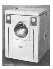
trieben durch Einphasen-Kurzschlussankermotor. Magnetventil für Wassereinlauf, Schaltschütze für Heizung und Zentrifugieren, verstellbarer Temperaturregler, Schwimmerschalter, Schalter für Steuerstromkreis, Signallampe und Motorschutzschalter eingebaut. Türverriegelung durch Elektromagnet. Klemmen  $3 \, P + N + E$  für die Zuleitungen. Radiostörvorrichtung vorhanden.
