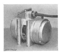
geschlossenen Räumen des Gehäuses und versetzen die Maschine in Schwingung. Imprägnierte Wicklung aus emailliertem Kupferdraht. Zuleitung verstärkte Apparateschnur, 5 m lang und fest angeschlossen. Gewicht 20 kg.
