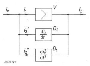
Fig. 1 Gleichstromverstärker mit Verzögerung Bezeichnung siehe Text
