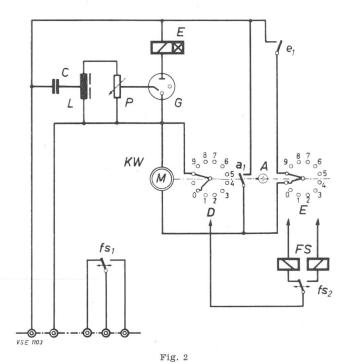
Prinzipschema eines Netzkommandoempfängers mit Kaltkathodenrelais
