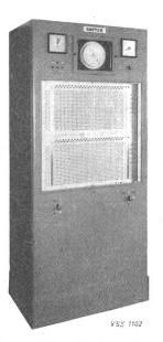
dotableaux mit derartigen Koordinatenwählern in Betrieb gesetzt, die sich hervorragend bewährt haben. Der Koordinatenwähler wird für Netzkommandoanlagen in zweierlei Typen hergestellt, und zwar als Einheit für 25 Doppelbefehle mit 48 Zeitreihen und als Einheit für den französischen Code von 40 Einfachbefehlen mit ebenfalls 48 Zeitrei-
