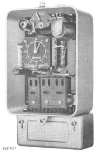
Fig. 1 Netzkommandoempfänger, offen, im Normalgehäuse
