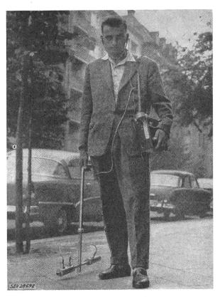
Fig. 3 Tonfrequenz-Empfänger mit Suchstock und Differenzspulen
