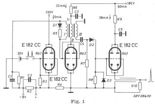
Schaltung des Impulsgenerators mit Triggerstufe
