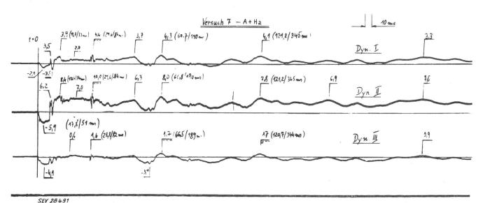
Fig. 5 Messwerte und Oszillogramm des Versuches Nr. 7 Mit Hartblei gedämpfter Riss einer Aussenkette
