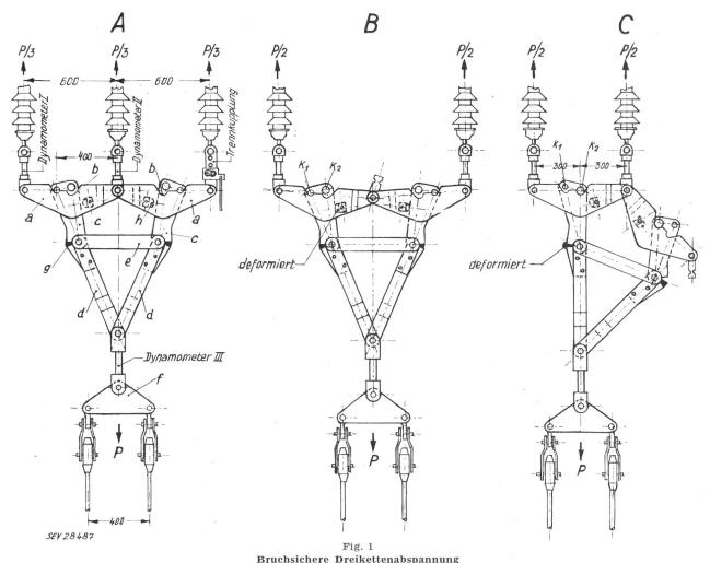
Die Figur zeigt die für den Versuch eingebauten Dynamometer und die Trennkupplung A Normalstellung; B Riss einer Mittelkette; C Riss einer Aussenkette Bezeichnungen siehe im Text
