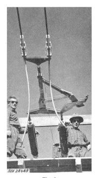
${\bf Fig.~3} \\ {\bf Dreikettenabspannung~nach~Riss~einer~Aussenkette}$
