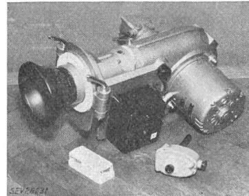
schlussankermotor. Separater Motorschutzschalter. Steuerung durch Schaltautomat, Photozelle, Kessel- und Raumthermostat. Zündtransformator mit Störschutzkondensator unten am Brenner. Der Brenner kann ausgeschwenkt werden, wobei ein einpoliger Druckknopfschalter den Stromkreis unterbricht. Anschlussklemmen vorhanden.
