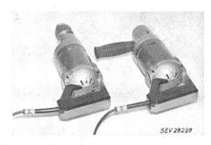
Die Handbohrmaschinen haben die Prüfung in sicherheitstechnischer Hinsicht bestanden. Sie entsprechen dem «Radioschutzzeichen-Reglement» (Publ. Nr. 117).
